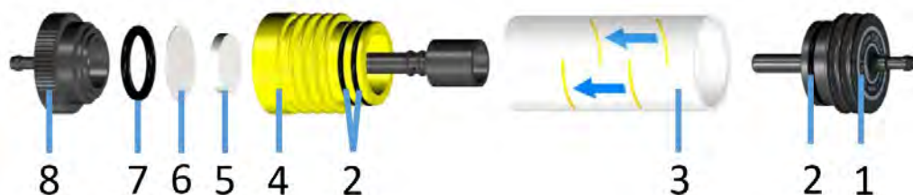
• Fig. 16: Sistema di pulizia gas – Elemento filtrante completo (KFP)
