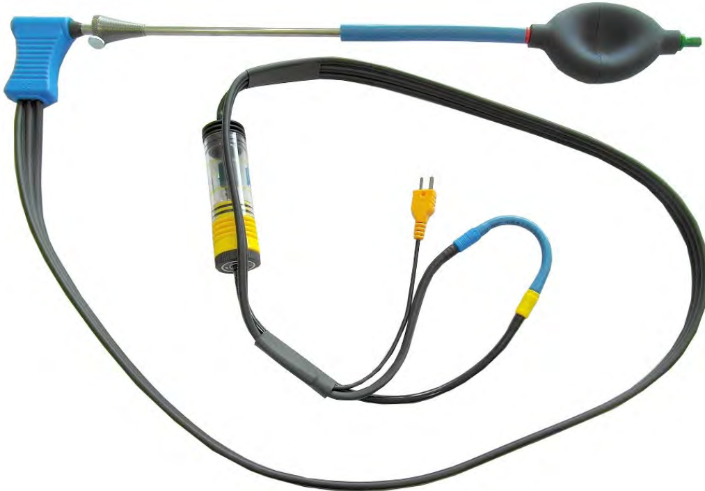
Fig. 5: Collegamento della sonda per la prova di tenuta (Nr.-art.: 511017)
